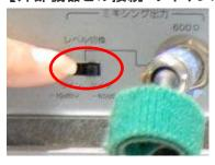
ワイヤレスチューナーのミキシ ング出力レベル切替をマイクに して、ケーブルを接続します。
