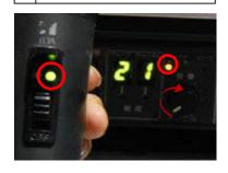
マイクのスイッチをONにすると、 ワイヤレスチューナーのアンテ 5 ナランプが点灯するので音量 を時計方向に回し調整します。
