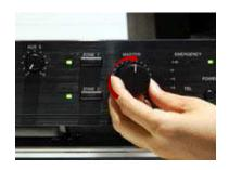
MASTER VOLを時計方向に 回します。 ※7の位置を超えると音が歪み やすくなります。
