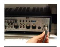
MIC1にマイクケーブルを接続 します。 ※カチッと音がするまで差し込 みます。
