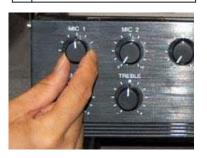
放送用アンプのMASTER VOL と、MIC1 VOLを時計方向に回 6 し音量調整します。
