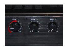
AUX1 VOLを時計方向に回し音量 調整します。 ※7の位置を超えると音が歪みや すくなります。
