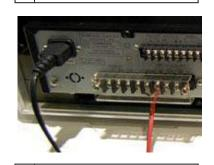
電源スイッチが【OFF】になって いることを確認して電源コンセ ントを接続します。
