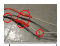
黒の端子に結び目のあるコー ドを接続します。 ※コードの+とーが接触すると 音が出なくなるのでテープ等を 巻いて絶縁します。
