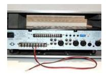
放送用アンプの裏側に付いて いるスピーカーケーブルと接続 します。
