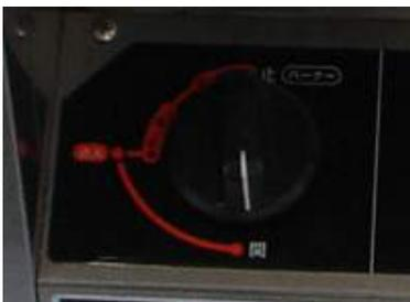
7 種火を確認したら『開』の方向に回してメインバーナーに着火します。
