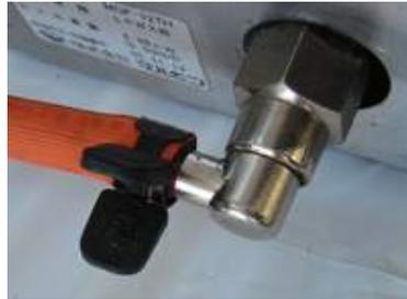
2 ガスホースを取付け、止め具で固定します。
