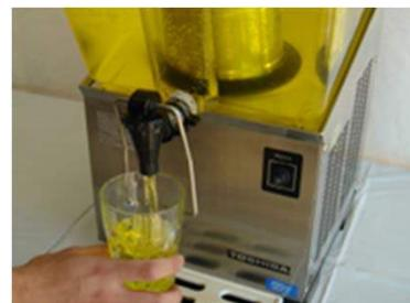
9 レバーにコップを押し付けるとドリンクが出てきます。
