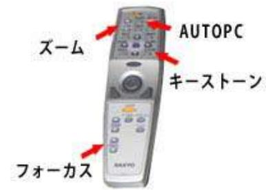
6 リモコンで、各種調整をします。フォーカス:ピント調整
