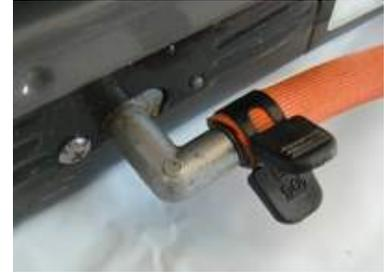
3 バーナーにガスホースを取付け、止め具で固定します。
